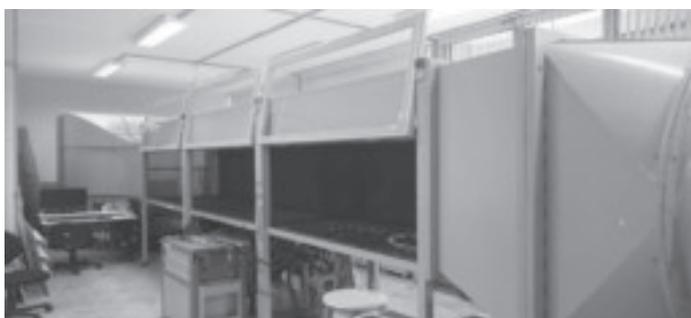
**Abb. 2** Überblick über den Windkanal in dem »Laboratory of Environmental Comfort and Applied Physics« (LaCAF) in Campinas, Brasilien © Frank Wellershoff
