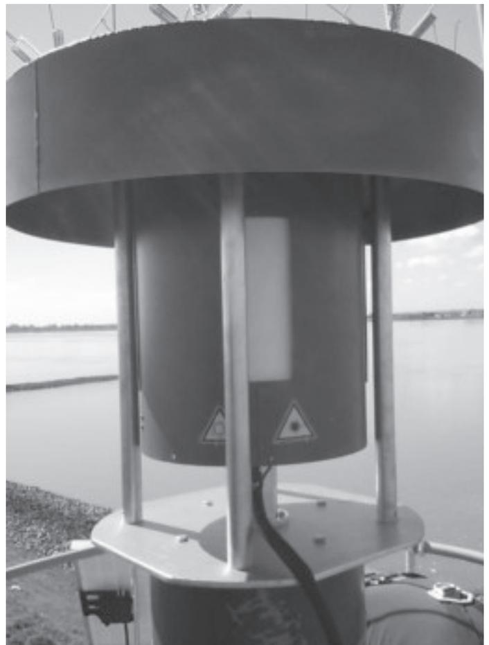
Abb. 2 Doppelzylinder als Gehäuse für das Messsystem
