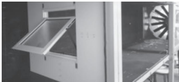
**Abb. 3** Fenster und Drucksensoren, installiert im Windkanal
