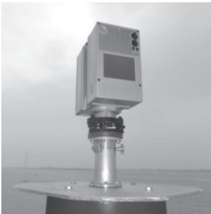
Abb. 1 Laserscanner Z+F IMAGER 5010 beim Einsatztest
