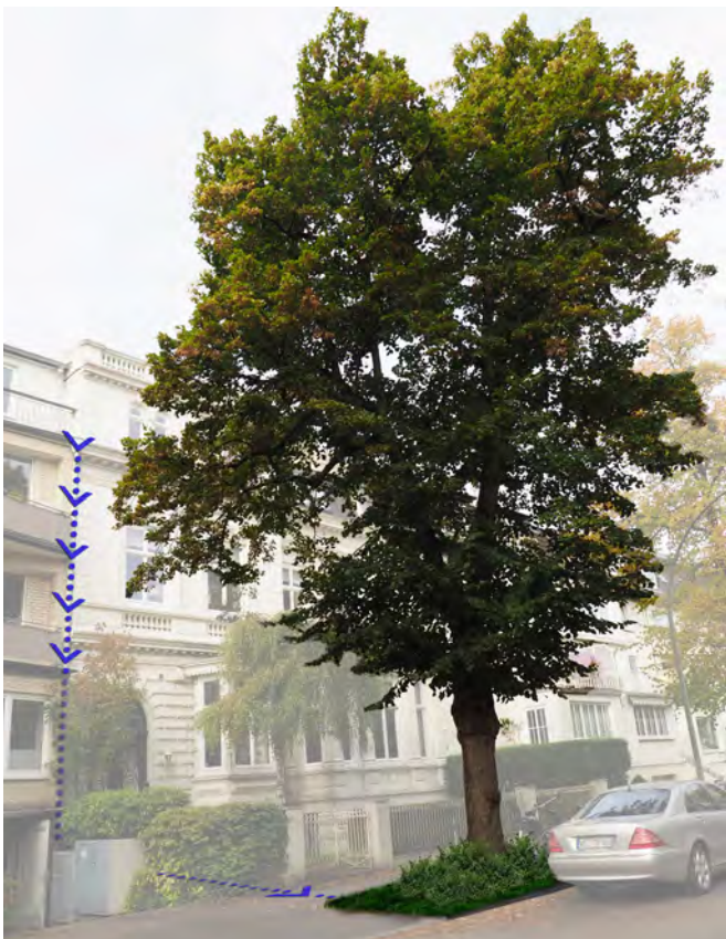
VISUALISIERUNG REGENWASSER UNTERIRDISCH VOM DACH (DARSTELLUNG: HCU)
